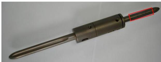
**Fig. 13(a):** Figura ilustrativa mostrando la localización de la marcación a láser y las informaciones aplicables al producto médico, las que permiten su rastreabilidad.
